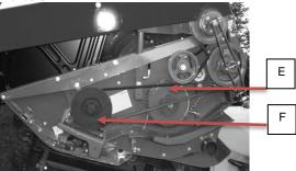
Den Mähmesserantriebsriemen (E) abnehmen und die Riemenscheibe (F) vom Schwenkgetriebe demontieren.
