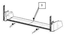
Batterieausschalter einschalten, Motor starten, Haspel anheben, danach die Sicherheitsstützen der hydraulischen Zylinder entfernen und in der Halterung arretieren. Vorsichtig mit dem Mähdrescher zum Rapstisch fahren. Dabei auf den mittleren Teil der Außenhaut (3) achten. Die Außenhaut (3) muss in der ganzen Breite über die Bajonette des Schneidwerks geschoben werden.
