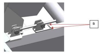
Die Schraubenabzieher an den Griffen des Schneidgeräts befestigen und sie anspannen.
