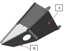
Nach der Demontage des Rapstisches die Verlängerung der Schutzhaube (B) montieren - im Satz mit dem Rapstisch mitgeliefert.
