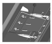
6. Die Platte "C" zum mittleren Tragarm des Rapstisches festschrauben
