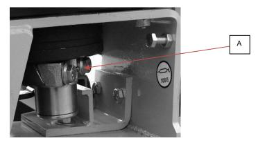
Schmieren vom Messerantriebsgetriebe (Abb.7)
