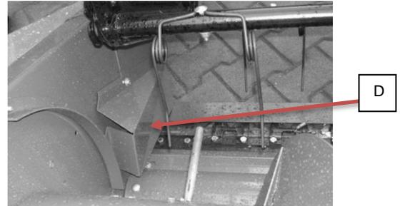
Die inneren Schutzhauben (D) demontieren – rechte und linke Seite. Zur Arbeit ohne Anpassung die Schutzhauben erneut montieren.
