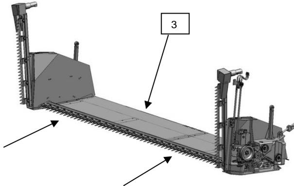
Batterieausschalter einschalten, Motor starten, Haspel anheben, danach die Sicherheitsstützen der hydraulischen Zylinder entfernen und in der Halterung arretieren. Vorsichtig mit dem Mähdrescher zum Rapstisch fahren. Dabei auf den mittleren Teil der Außenhaut (3) achten. Die Außenhaut (3) muss in der ganzen Breite über die Bajonette des Schneidwerks geschoben werden.
