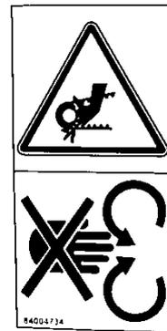
Schutzeinrichtung bei laufendem Motor nicht öffnen oder entfernen
