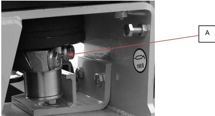
Schmieren vom Messerantriebsgetriebe (Abb.7)
